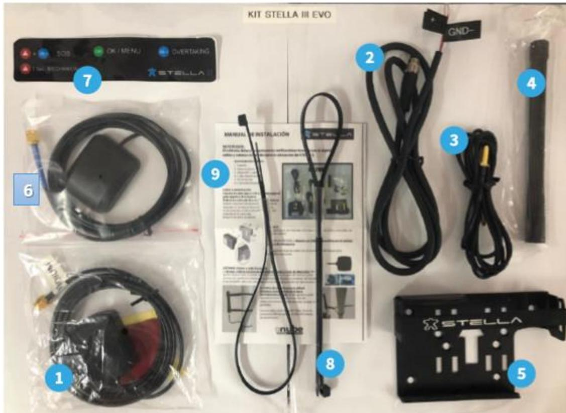
1.Antena/Iridium / 2.Cabo de alimentação / 3.Cabo coaxial / 4.Antena RF / 5.Suporte
