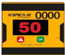
Dentro da zona de velocidade limitada indica a vermelho a velocidade máxima permitida. Apresentada fixa não excede a velocidade
